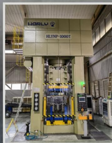
本机为框架式智能伺服液压冲。主要适用于金属或非金属零件的冲切、压印、成型、深拉伸、整形及压力精密压装，组立装配等；眼镜、锁具及五金零件的压制、电子接插件、电器零件、电机转子、定子压装等。特别适用于铝、镁、铅合金压铸制品的毛边冲切及整形，塑橡胶、粉末制品的压制等；手机配件、汽机车、家用电器、精密部件行业用途最广泛。
