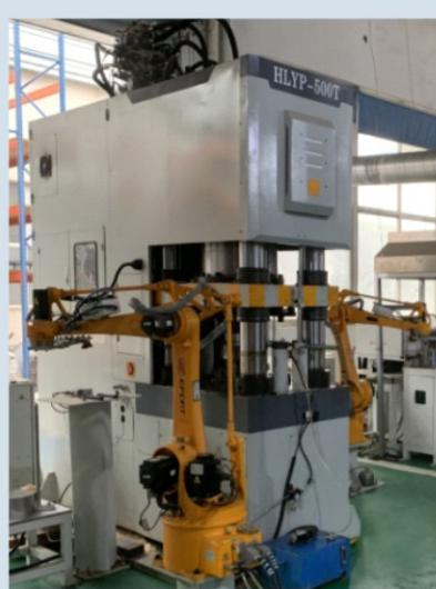
自動化上選配機械手及上料裝置,搭配自由定義步進邏輯系統軟件,實現設備全自動生產。智能上設備選配掃描槍,模具識別裝置,搭配生產信息化管理系統,實現智能化信息化生產。同時設備配備了圖構點檢,智能維護等功能,保證生產的可靠性。
