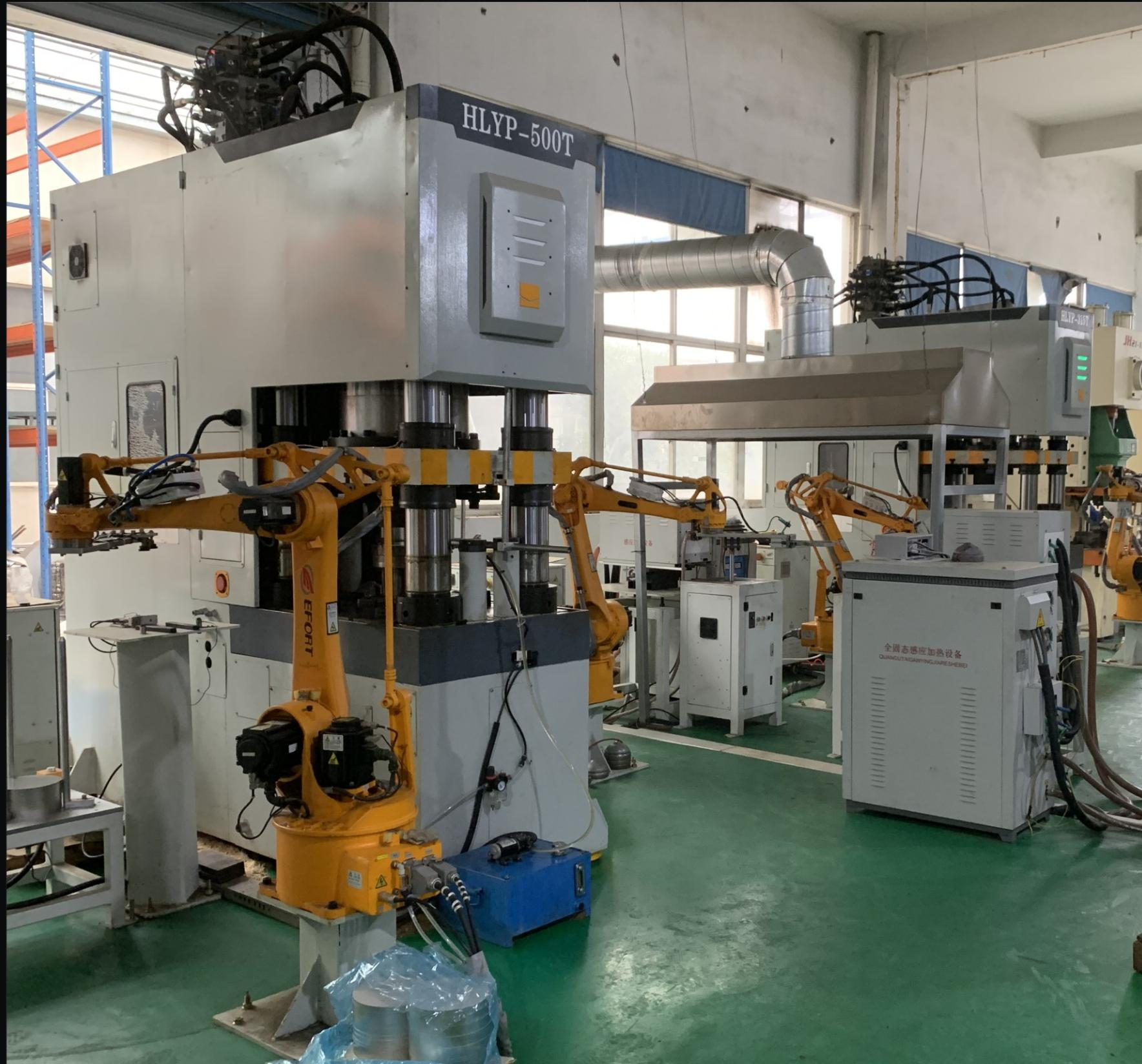
本系列机器为四柱式智能伺服液压冲。主要适用于金属或非金属的压形、拉伸、弯曲、翻边、精切、精冲、挤压、精密压花及精密压装等工艺。
