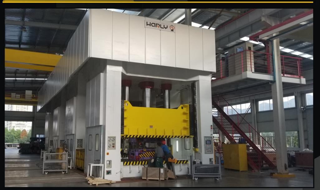
本机为大型冲压件成型液压机。 主要适用于汽车冲压件,家用电器、厨房用品等金属薄板件的深拉伸,浅拉伸,冲压,翻边、整形等工艺,特别适用于汽车冲压件的拉伸及冲压成型等工艺。
