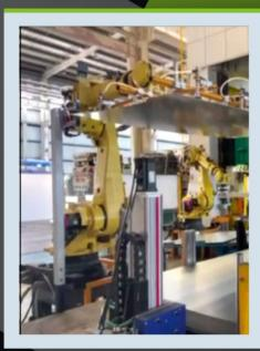
自動化上选配機械手及上料装置,搭配自定义步进程序,实现设备全自动生产。智能上设备选配扫描枪,模具识别装置,搭配生产信息化管理系统,实现智能化信息化生产。同时设备配备了图构点检,智能维护等功能,保证生产的可靠性。
